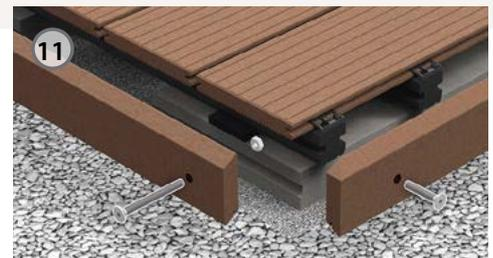
Den Grundsätzen des konstruktiven Holzwerkstoffschutzes folgend, empfehlen wir immer eine Verlegung mit mindestens 2 % Gefälle in Längsrichtung der Diele, damit Wasser vom Haus weggeführt werden kann. Bei Einhaltung vermeiden Sie Wasserflecken und Staunässe sowie weitergehende Schäden am Gebäude.
