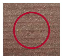
natürlicher Fasereinschluss nach mechanischer Behandlung
